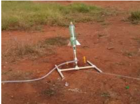
Figura 2: Base de lançamento fixa no chão Fonte: o autor
