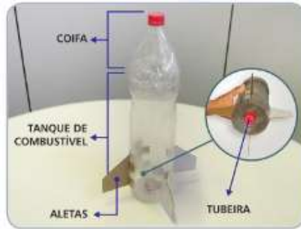
Figura 1: Partes do foguete de garrafa PET
