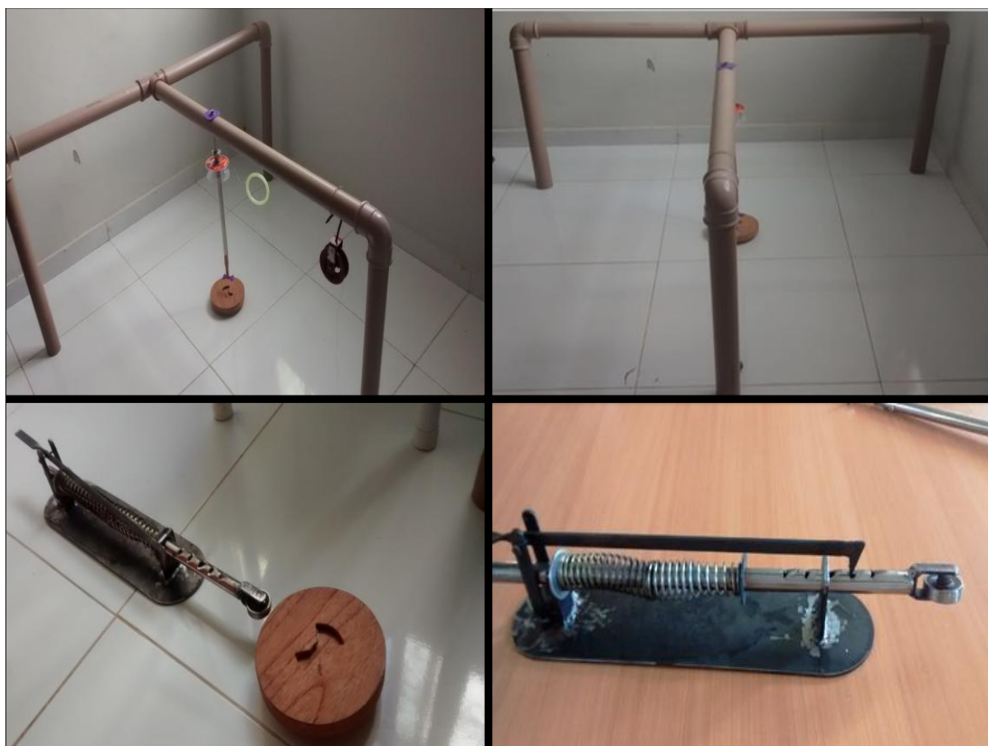
Figura A-3: suporte de PVC e ferrolho.
